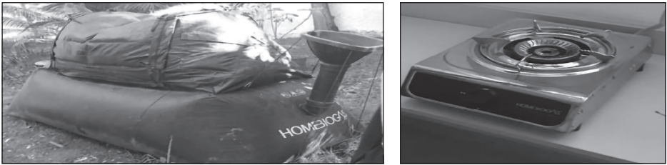
Figura 1 – Fotos do biodigestor e do fogão acoplado, que fica localizado no laboratório de Ciências da escola
